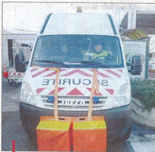
Prado-Carénage est équipé depuis longtemps, lui, de ce "camion-poussette", bien utile pour dégager un véhicule en panne.
